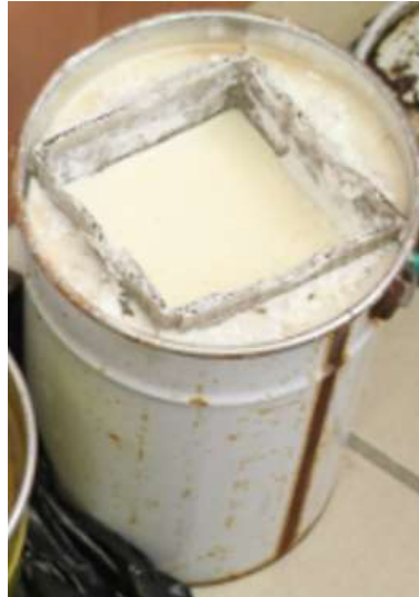
FIGURA 5-21. TAMAÑO Y DISPOSICIÓN DE LA MECHA EN LAS LATAS SUMINISTRADAS POR S.A.T. ROYAL.
