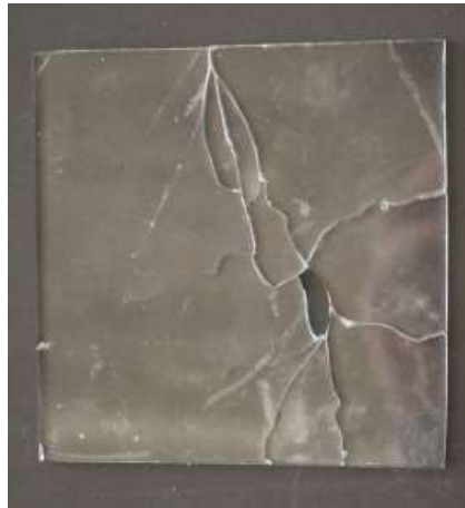
FIGURA 5-15. CRISTALES DE VIDRIO CONVENCIONAL ROTOS COMO CONSECUENCIA DEL CHOQUE TÉRMICO.
